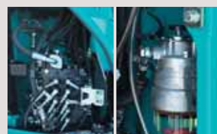
コントロールバルブ/ウォータセパレータ
