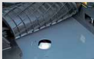
フロアマット下に設けた ウォッシュ液タンク
